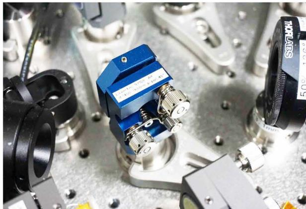
LAYERTECのミラーの固定には安定性に定評があるファーストメカニカルデザイン (FMD) のマウントを使用
